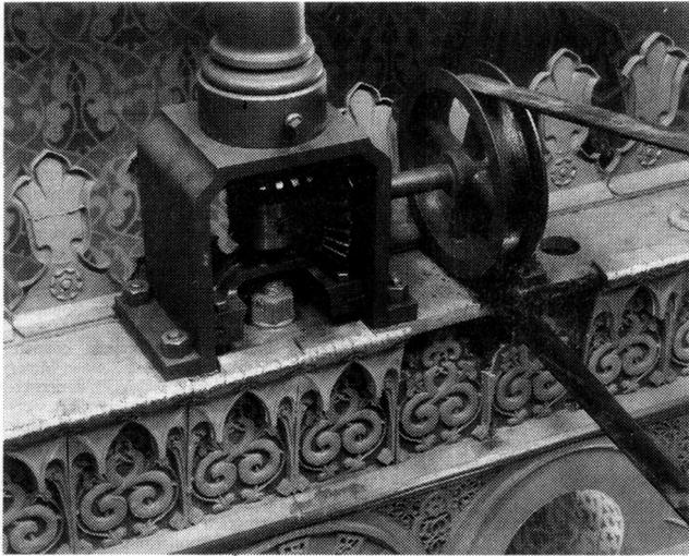
Die handfeste Technik des Kegelradtriebes für den Fliehkraftregler der Dampfmaschine strahlt noch den Charme der frühindustriellen Zeit und unverbrauchten Maschinenstolz aus
