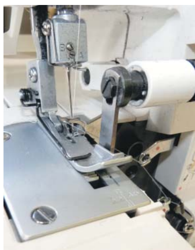
Nadel mit dem Nadelöhr unten ohne eingefädelt den Oberfaden, Stofftransport und unter der geöffneten Platte das runde Schiffchen mit dem CB-Greifer für den Unterfaden. Oben und rechts eine Overlockmaschine.
