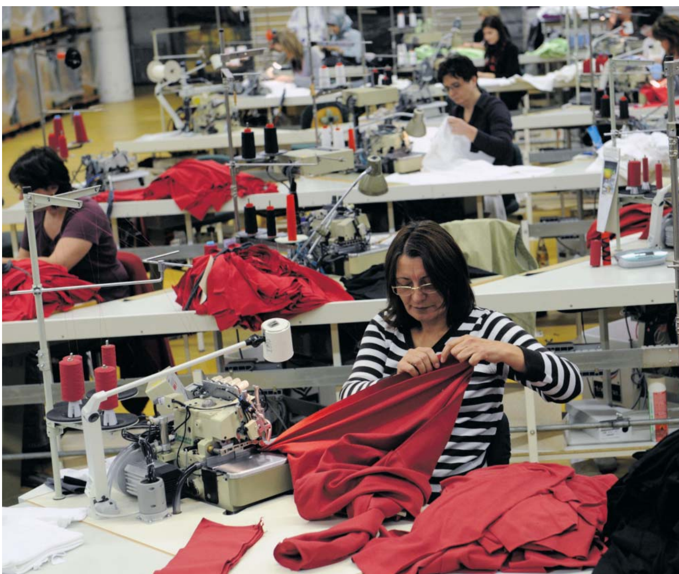
Akkord: Hier entsteht eine Randnaht mit der Overlockmaschine
