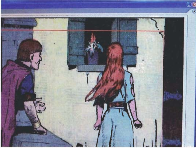
HIER KANN MAN SEHEN, WELCHE AUSWIRKUNGEN ES HAT, WENN BEIM ZEITUNGSDRUCK DIE FARBE VERRUTSCHT IST – WIE HIER DAS ROT NACH OBEN –, DAS WIRKT SICH DANN SOGAR AUF DIE KONTUREN AUS, ETWA
