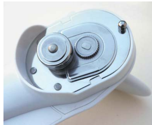
Moderner Randschneider: schematisch im Patent von 1963 und real in Gestalt eines Öffners von Rossmann. Der Dosenrand wird vom Schneiderad außen aufgeschnitten.
